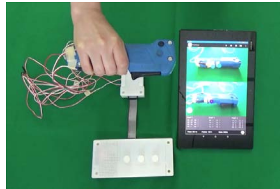
図1 把持力分布測定システム
